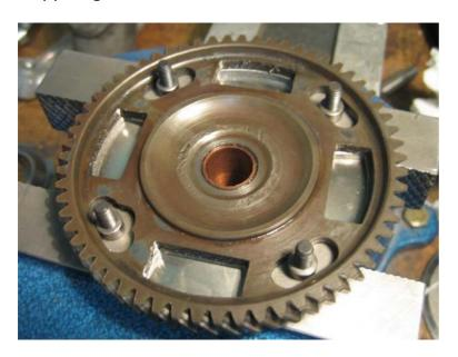
In die Primär wird jetzt eine Primärfeder in eine Seite der Tasche eingelegt. In die andere Seite wird ein breiter Schlitzschraubendreher gestellt. Dann wird die Feder mit Druck von Schraubendreher und von oben komprimiert und in die Tasche gedrückt. So werden alle 4 Federn in ihre Sitze in den Taschen gesetzt. Wichtig ist, dass die Federn auch im Spacer sitzen, nicht nur im Zahnrad!
