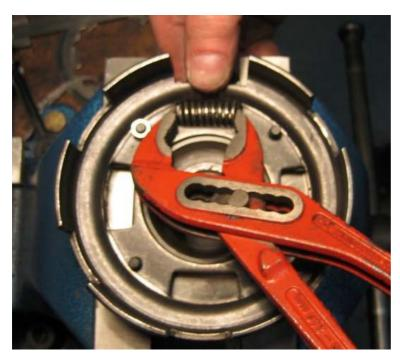
Dann können die Federn mit Hilfe einer Wasserpumpenzange komprimiert und in die Federtaschen gesetzt werden. Das ist nicht ganz einfach, geht jedoch. Zu empfehlen ist dabei eine Schutzbrille, da die Federn unter hohem Druck stehen.
