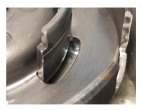
Die Schrauben sollten noch gekürzt werden, um ein Berühren der unteren Druckplatte völlig auszuschließen. Normalerweise reicht es, sie um ca 2mm zu kürzen.
