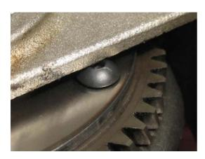
Sollten die Schraubenköpfe am Gehäuse schleifen, kann man nach dem endgültigen Zusammenbau des Kits die Köpfe noch etwas flacher schleifen. Im Normalfall dürften sich allerdings hier keine Probleme ergeben.
